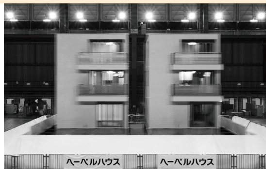
制震フレーム「ハイパワードクロス」 (ハイパワード制震ALC構造)
